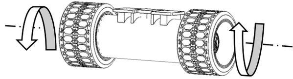
Durante le manovre ad alto angolo di sterzo l'elettronica di AMOV M140 genera la contro-rotazione delle ruote anteriori e riduce la velocità, cosicché la macchina possa muoversi in spazi ridottissimi dimostrandosi costantemente stabile. Nel corso delle operazioni di sollevamento, allorché il braccio raggiunge alfa gradi la velocità di trazione viene limitata automaticamente.
