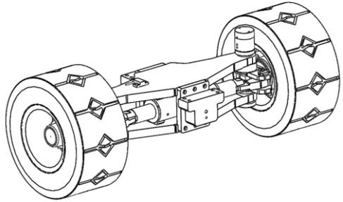
L'assale posteriore sterzante di AMOV M140, interamente costruito presso il nostro stabilimento, garantisce robustezza strutturale, stabilità e alto angolo di sterzo.
