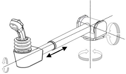
Un'altra pregevole particolarità di AMOV M140 è il sistema di regolazione a 3 assi del joystick, per mezzo del quale il guidatore può adattare lo strumento di manovra alla sua corporatura.
